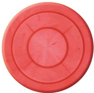
Stampata fatta con ugello standard con masterbatch al 2% master batch, si noti la cattiva dispersione del colore e le particelle non plastificate nella stampata.
