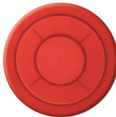
Stesso prodotto, stesso 2% di masterbatch ma processato con un Mixer Statico Nickerson. Il colore più scuro è il risultato di una buona omogeneizzazione fatta dal mixer che ha come risultato di una distribuzione uniforme del colorante, senza particelle non plastificate.
